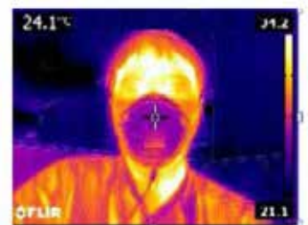
Met AIR+ Micro Ventilator, thermische foto laat door blauw/paars de lagere temperatuur in het masker zien
